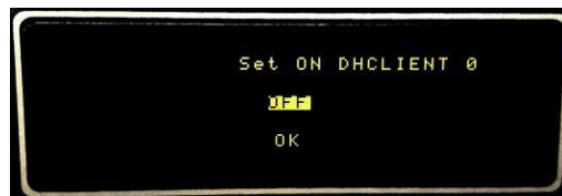
Рисунок 14— Настройка встроенного DHCP клиента
