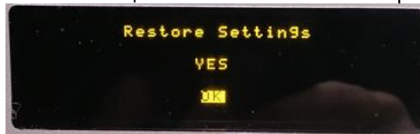
Рисунок 23.5 — Настройка Restore Setting
